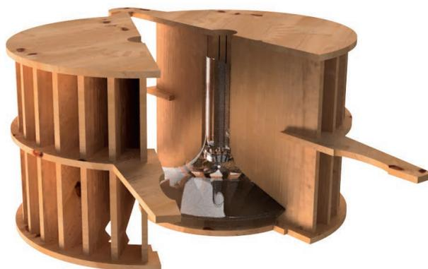
Dans l'exemple de la carafe, les lamelles du moule sont implantées en éventail sur une base. En raison de la forme particulière de la pièce à réaliser, qui présente un col étroit, une panse large et un fond plat, les lamelles se touchent en haut du moule, mais se trouvent écartées à sa base, créant des jours.
