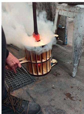
Lorsque le soufflage est terminé, la pièce est retirée du moule puis mise à l'arête de recuisson. Enfin, une fois refroidie, la pièce est parachevée.
